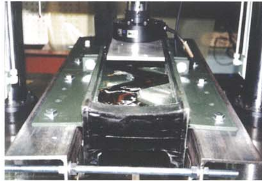
過酷な水張試験にも耐える4000回伸縮 (10年相当) ※写真は載荷試験
