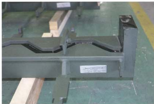
地覆部 (歩車道境界部) の立上げ加工 (別途制作)
